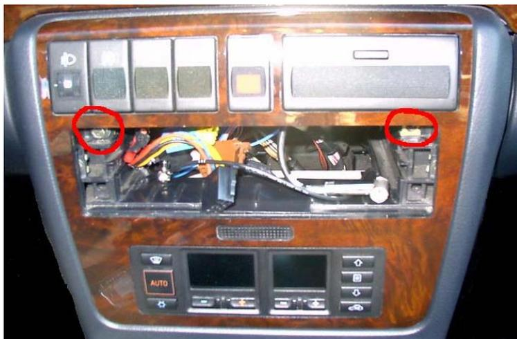
Nachdem Ihr die beiden Halteschrauben der Klimaautomatikbedieneinheit rausgeschraubt habt, könnt Ihr diese schon vorziehen und die 4 Steckverbindungen lösen!
