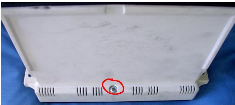
Nachdem Ihr diese drei Schrauben heraus geschraubt habt, könnt Ihr das Bedienteil mit Display von dem Gehäuse lösen. Um die beiden Teile endgültig zu trennen, das mehradrige flexible Kabel abnehmen. Dabei auf die Haltenase achten.
