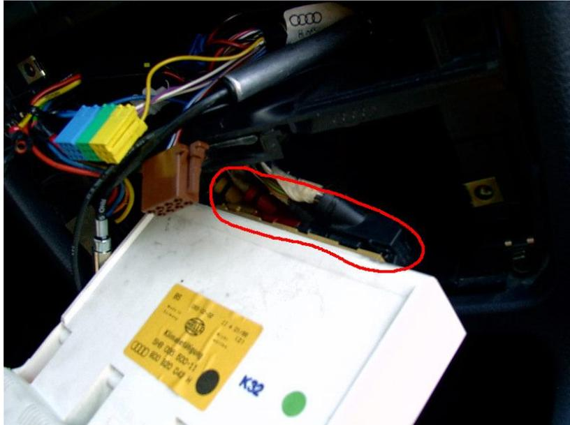
Die Frontblende ist mit drei Kreuzschlitzschrauben am Gehäuse befestigt. Zwei an der Oberseite, wo auch die Glühbirnen zu erkennen sind, und eine auf der Unterseite
