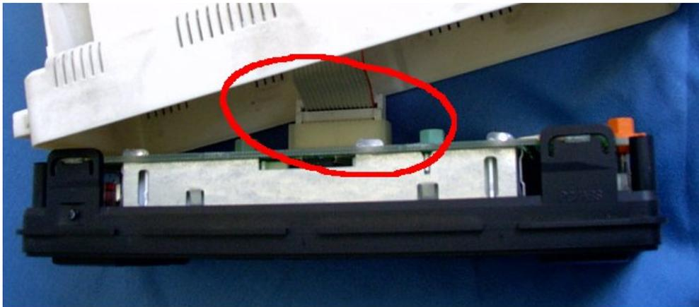
Um jetzt die Platine mit dem Display zu trennen, einfach die mit einem Sicherungskleber versehenen Klammern öffnen.
